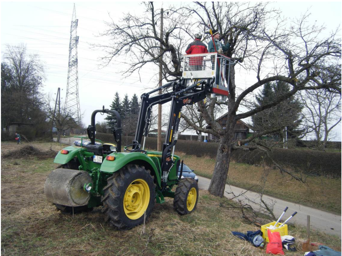
Für sicheres Arbeiten steht uns ein Traktor mit Arbeitsbühne zur Verfügung.
